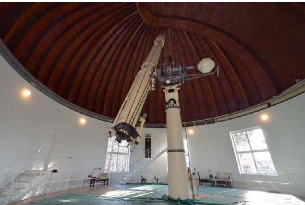
Велики рефрактор - екваторијал, Zeiss 650/10550 mm
