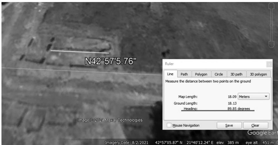
Слика 9. Сателитски снимак са опцијом виртуелног геодетског мерења. Географске координате су на дну слике а надморска висина E = 385 м
