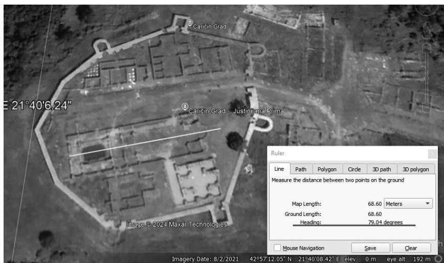
Слика 2. Сателитски снимак Google Earth-а са опцијом виртуелног геодетског мерења. Видимо да је аксијални правац цркве на азимуту A = 79.04^\circ ( 79^\circ 2' ). Географске координате цркве су на дну слике. Елевација је E=383\text{m}
